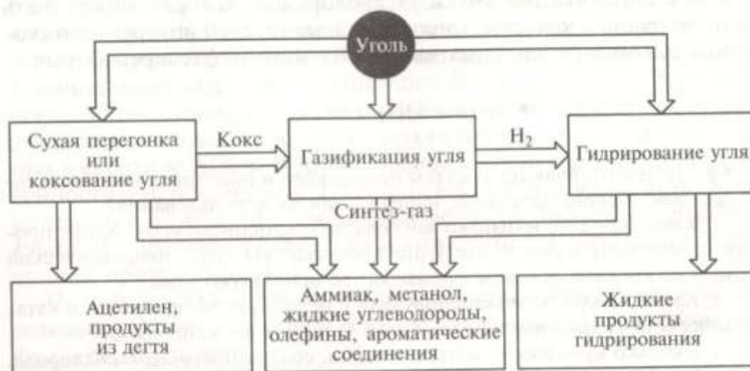
Рис. 14.1. Схема переработки каменного угля
